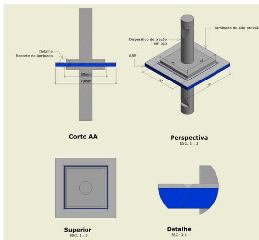
Ilustração 1 – corpo de prova e dispositivos de tração
