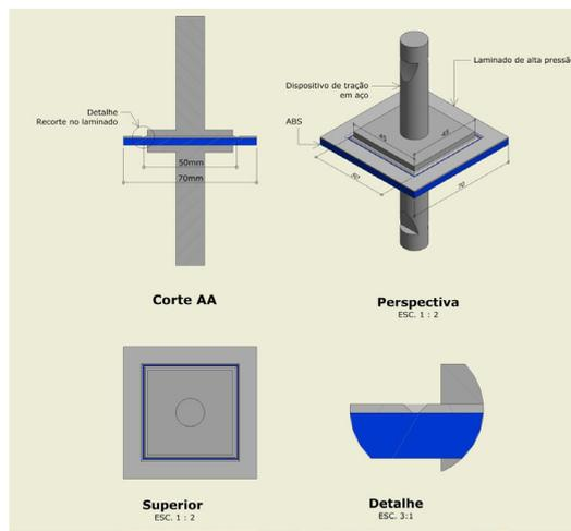
Ilustração 1 – corpo de prova e dispositivos de tração
